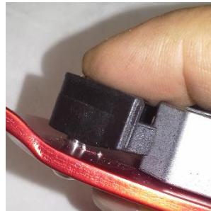
Utiliser la pointe du couteau ou le tournevis fin pour engager la boucle du ressort dans son logement. Contrôler par la face externe du flasque que la boucle du ressort est bien implantée dans son logement et finir de pliquer le taquet contre le flasque. Visser.
